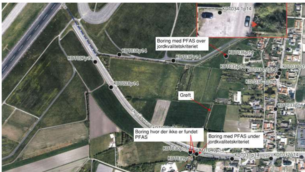
Figur 14 – Boringer med PFAS-analyser ved krydsning af Hovedgrøften ved Englandsvej.
